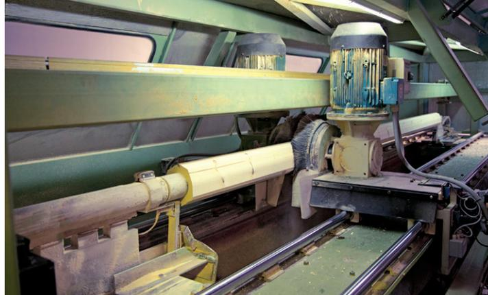
L'embase provenant de l'usine de supports acier de Kangasniemi, est alors emboîtée en force et collée sur le fût. Les embouts ou autres pièces prévues pour la fixation de luminaires et/ou accessoires sont également positionnés sur ce poste.
