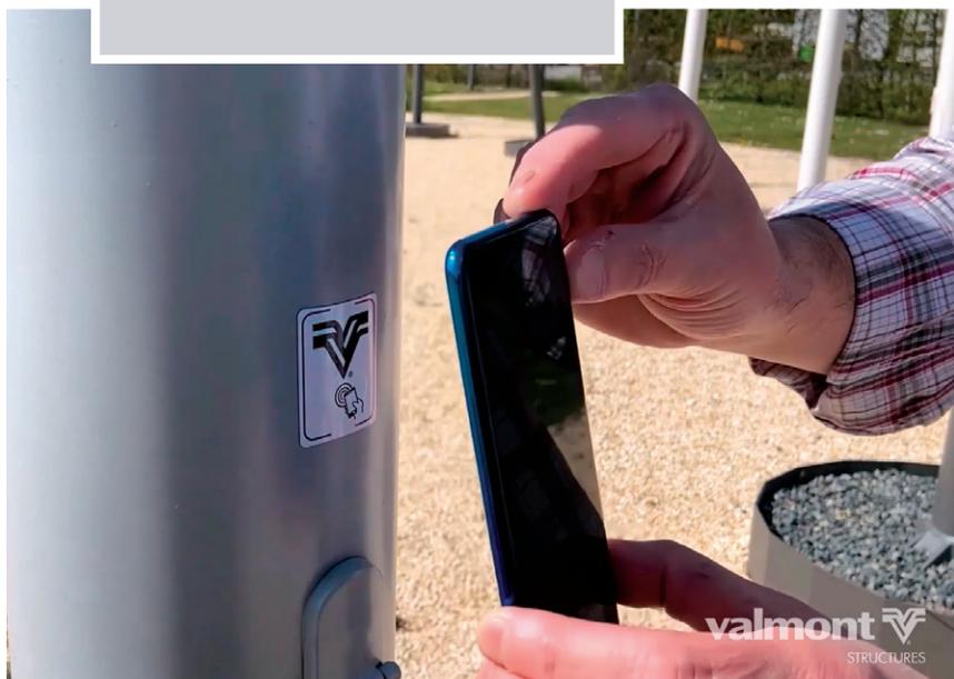
RFID (Radio Frequency IDentification), ou radio-identification, est une technologie qui permet de sauvegarder et récupérer des données à distance.
